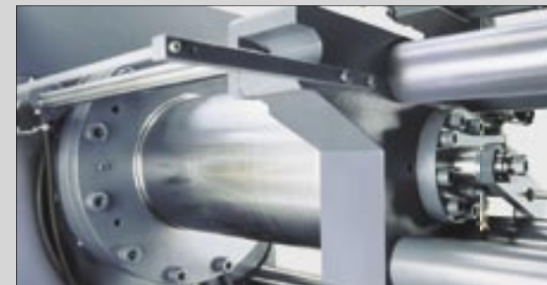
Cilindro de cierre hidráulico central con expulsor de fácil acceso
