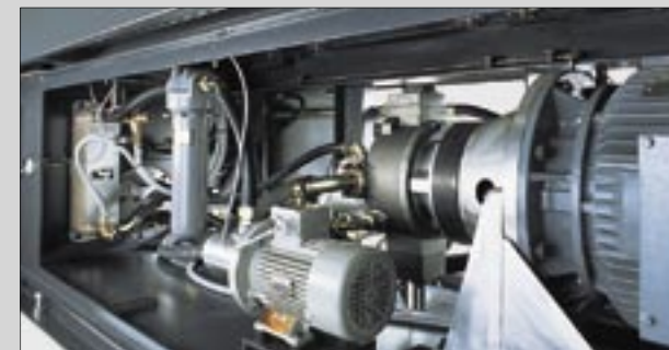
Acceso directo a la instalación de bombas y filtros
