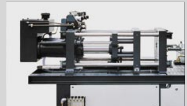
Adaptación opcional de la altura de montaje del molde mediante cambio sencillo del bulón de apriete
