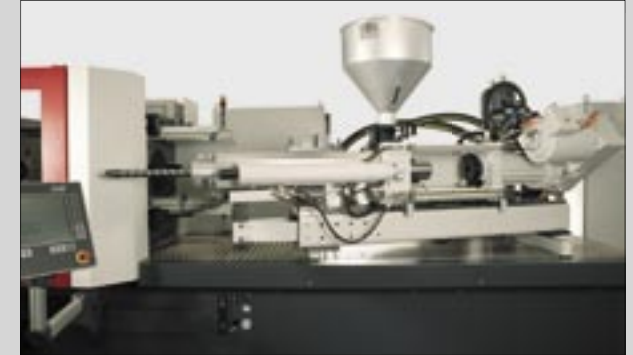
Unidad de inyección con giro transversal para un fácil mantenimiento
