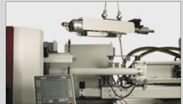
Rápido cambio del husillo y la cámara para nuevas tareas productivas
